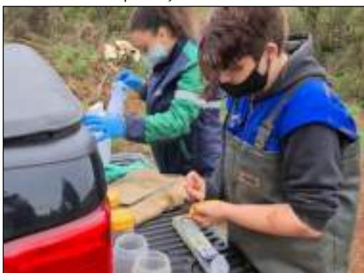
Foto 364. Medições *in loco* dos parâmetros da água com sonda multiparamétrica.
