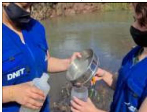
Foto 363. Material sendo armazenado em frasco plástico identificado e com a presença de formalina 4%.
